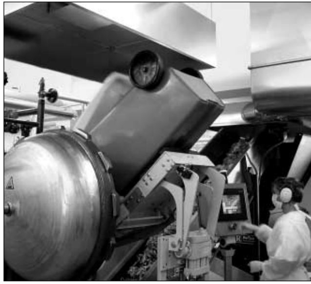
Jäätmeautoklaav. Jäätmekonteinerite tühjendamine autoklaavi.
